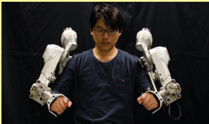
Exoesqueleto robótico de rehabilitación Harmony, Fuente: Cockrell School of Engineering, NSF.
